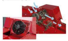
El mecanismo de atado tiene dos anudadores. Fabricados y testados durante el proceso de ensamble para asegurar la calidad, pueden utilizar plástico o henequén.
